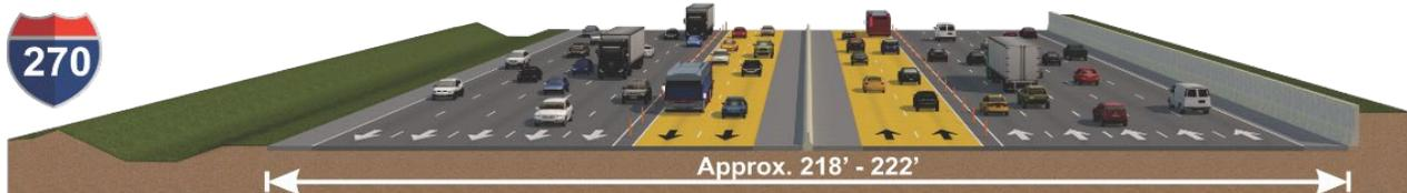
La Alternativa Preferida incluye el reemplazo total del puente ALB con un puente nuevo y más ancho (no ampliar el puente existente) para acomodar los dos carriles HOT en cada dirección. El puente existente tiene casi 60 años y se
